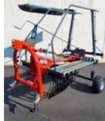
FELLA, ANDAINEUR PORTÉ JURAS 456, 2022 Andaineur monorotor porté 4,50 m, 12 bras, 4 dents/bras. 7 990€ HT Démonstration 6 390€ HT
