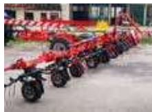
SIP, FANEUSE SPIDER 1100/10T, 2022 11m, 10 rotors, Boucliers anti enroulement, réglage hydrau de la hauteur de travail, roues 380/55-17, rideau de bordure manuel 30 990€ HT Démonstration 24 790€ HT
