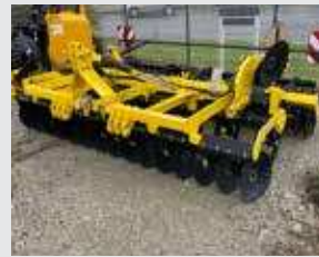
BEDNAR, DÉCHAUMEUR À DISQUES SWIFTERDISC XN 4000 R, 2022 Déchaumeur à disques Ø510mm, 4m fixe. Rouleau V-Ring, réglage hydraulique de la profondeur, éclairage. 25 490€ HT Démonstration 20 390€ HT
