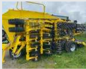
BEDNAR, SEMOIR OMEGA 00 4000F, 2021 Semoir traîné 4 m pour semis simplifié. Double trémie 4000 L (60/40). Inter rangs 12,5. Réglage hydraulique de la profondeur et de la pression, 2 doseurs. 100 000€ HT Démonstration 80 000€ HT
