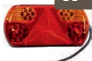
Avec triangle intégré. Fonctions : stop, veilleuse, clignotant. Gauche/droit. Dim : 142 x 296 x 45 mm. Entraxe de fixation: 152 mm. Réf. 17728
